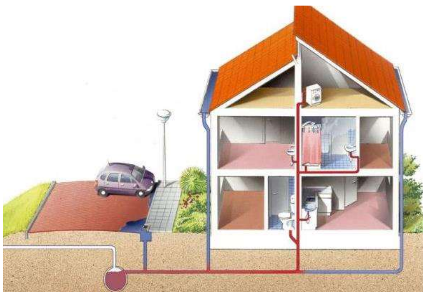
Afkoppelen – gemengd stelsel (bestaand)
